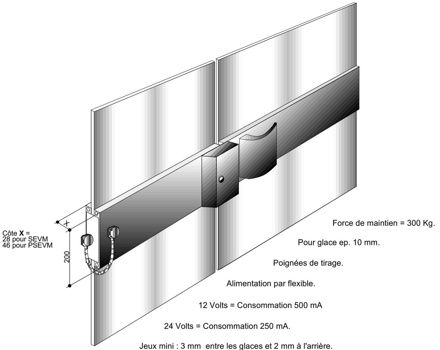
Le bandeau référence **SEVM** s'adapte sur des glaces avec encoches Guidotti de hauteur 105mm et 160mm. Il peut ainsi se placer en lieu et place des nos bandeaux SE125 et SE200 (nous préciser pour la commande)
